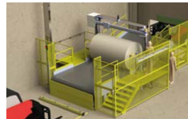
Machine dédiée à l'automatisation de la découpe et du déroulage des bobines non conformes.
